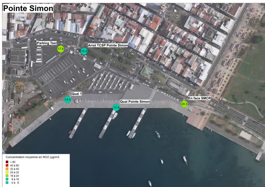
Figure 9: Concentrations moyennes (µg/m 3 ) en NO 2 à l'issue des 4 campagnes sur les sites de mesure du pôle de la Pointe Simon.
